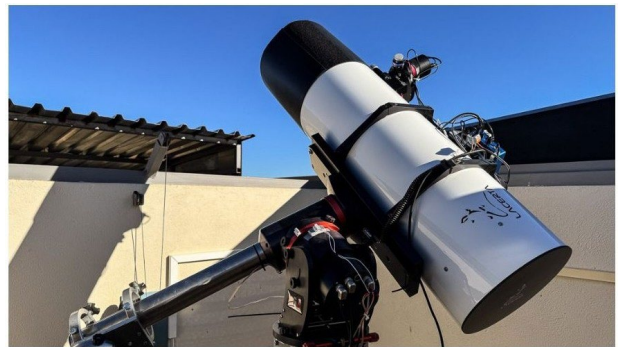
Abb. 2: IAS Remote-Teleskop 30 cm Photo-Newton, Montierung ASA DDM85XL-A, Kamera QHY 268M
