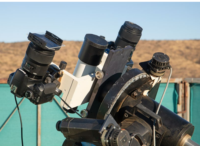
Abb. 3: Kameras und Leitrohr auf der Fornax-51-Montierung der IAS
