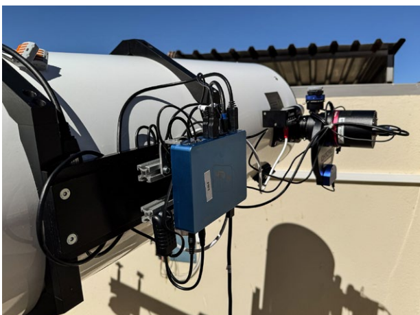
Abb. 6: Kabelsalat mit Pegasus Powerbox und QHY 268 M
